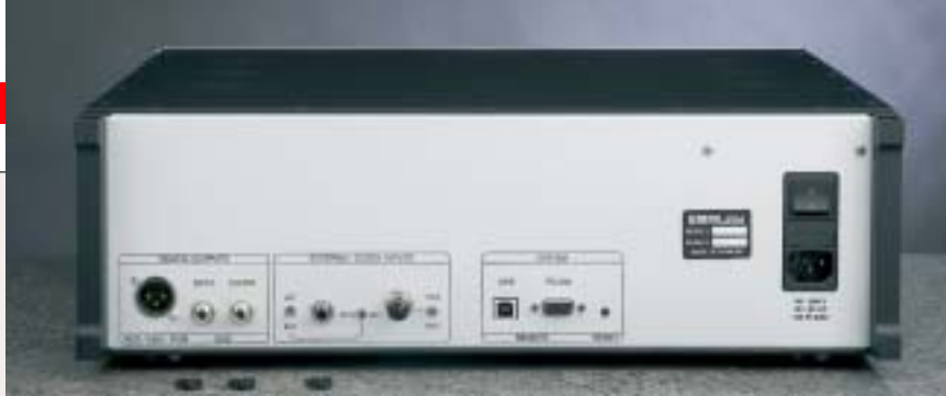
Il pannello posteriore del lettore CDSD SE denota la presenza di uscite di segnale su presa XLR, di segnale e clock su connettori ottici ST, oltre agli ingressi per l'asservimento al clock di apparecchiature esterne su presa ST e BNC. Gli interruttori sono atti a predisporre le diverse modalità funzionali.
